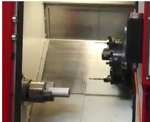
شكل رقم ٧٠: الشغلة بعد التثبيت في الظرف
