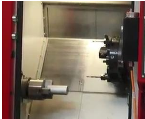
شكل رقم ٣٦: الشغلة بعد التثبيت في الظرف
